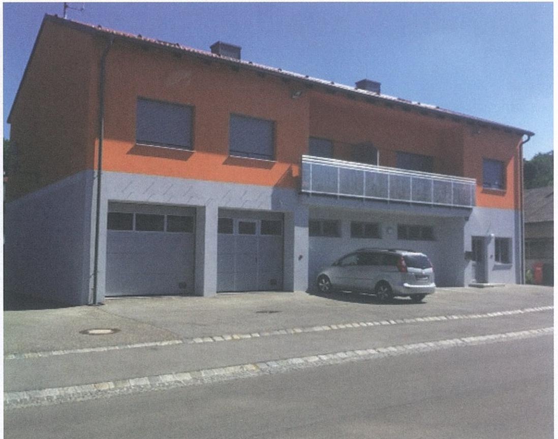
Das erste Projekt im Rahmen des Energiekonzeptes: Das Feuerwehrhaus und Wohnhaus Oberrohrbach wurde thermisch saniert (Dach, Tore, Fenster, Fassade).
